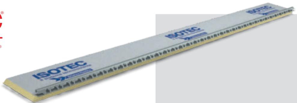
**Isotec XL e Isotec XL plus:** il profilo in acciaio, rivestito con lega alluminio-zinco-silicio di altezza 4 cm integrato nel pannello, presenta delle asolature che consentono lo smaltimento dell'acqua e assicurano una ventilazione pari a oltre 200 cm<sup>2</sup>/m di gronda. È dotato di una nervatura longitudinale, sulla parte piana di appoggio al pannello in poliuretano, che ostacola l'eventuale risalita capillare dell'acqua.
