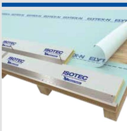
1 - Consolidare il pannello Isotec Linea alla struttura, utilizzando fissaggi meccanici, partendo dal canale di gronda e proseguendo verso il colmo. Avvalersi, per tale operazione, dei fori presenti nel correntino metallico.
