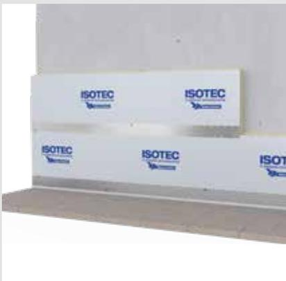
1 - Il pannello Isotec Linea viene fissato alla struttura portante tramite tasselli ad espansione e viti d'ancoraggio passanti attraverso il correntino. Tipo e numero di fissaggi dipenderanno dalla struttura e dal peso del rivestimento.
