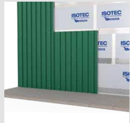
3 - Vincolare il rivestimento al correntino metallico, ricorrendo all'utilizzo di fissaggi meccanici, di tipologia e in quantità da definirsi in base al materiale di finitura scelto.
