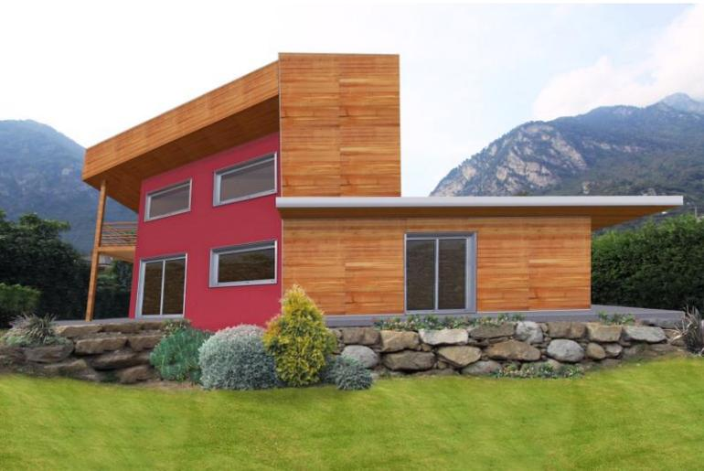
Un progetto architettonico che rompe con gli schemi tradizionali locali, proponendo una struttura portante in legno lamellare con copertura piana, facciate prive di gronda, completamente esposte all'acqua battente, asimmetrie: questo in sintesi il concept del progetto della nuova villa unifamiliare realizzata a Chiavenna, con tecnologie e materiali innovativi.
